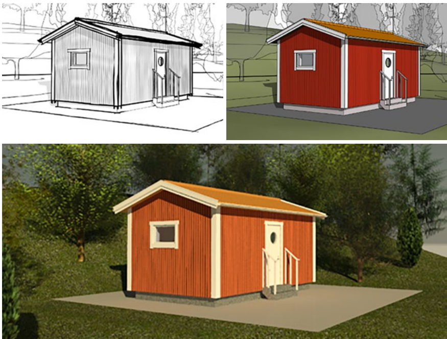
Tre exempel på olika redovisning i perspektiv, alla skapade direkt i CAD/BIM-program: Dolda linjer (uppe tv), skuggning (uppe hö) samt rendering (nederst).
