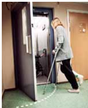
Automatiska dörröppnare och hiss underlättar för många. Det så kallade dörrsvepet bör markeras i golvet. Om nivåskillnader i marken jämnas ut är det enklare att ta sig fram med rullstol.
